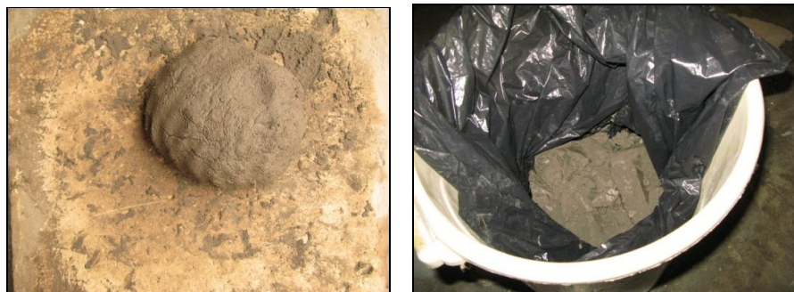
Porção de massa sobre o tabuleiro de gesso para retirada do excesso de água e a acomodação em saco plástico preto. Lajedo de Soledade - Apodi/RN. Fonte: Ítegra Pesquisa e Consultoria, 2009
