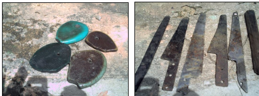
Pedaços de chinelos e facas usados para dar o acabamento nas peças – Felipe Guerra/RN. Integra Pesquisa e Consultoria, 2009
