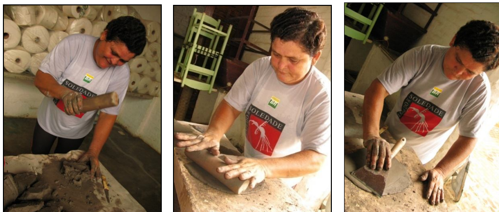
Abertura da massa com auxílio de rolo de madeira e alisamento com a espátula para moldar. Lajedo de Soledade - Apodi/RN. Fonte: Ítegra Pesquisa e Consultoria, 2009
