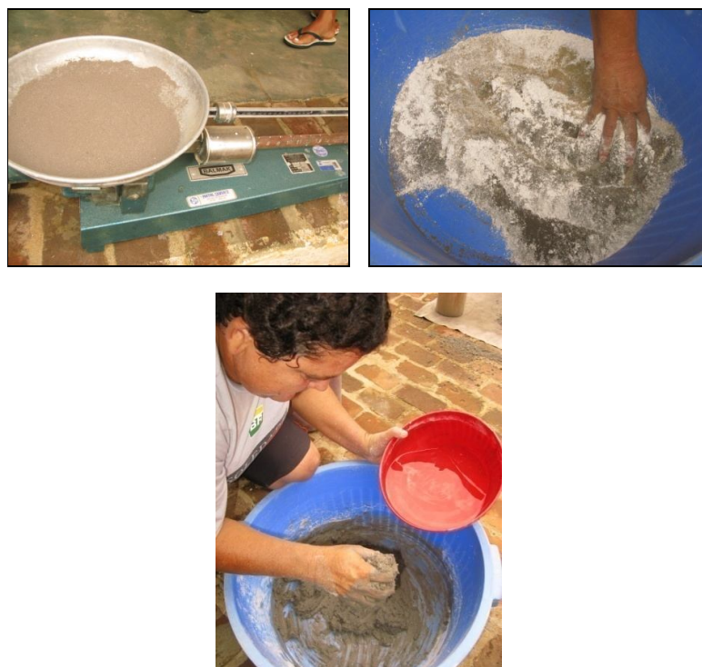
Preparo da massa para produção da cerâmica – pesagem, homogeneização dos ingredientes secos. Lajedo de Soledade - Apodi/RN. Fonte: Íntegra Pesquisa e Consultoria, 2009
