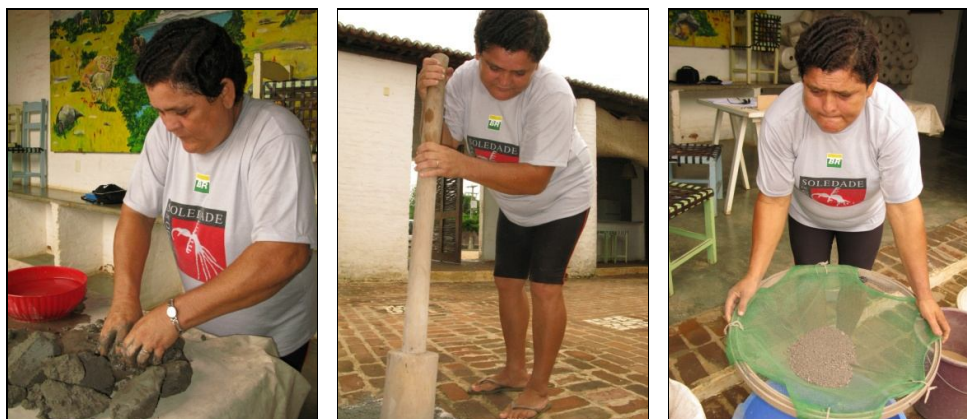
Seqüência do preparo da massa para produção da cerâmica – torrões de argila bruta, trituração e peneiramento. Lajedo de Soledade - Apodi/RN. Fonte: Íntegra Pesquisa e Consultoria, 2009
